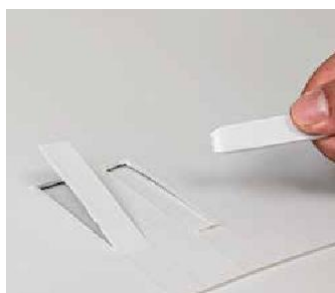
Test odrywania (2 cm z odrywaniem poza połączeniem)
