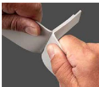
Test odrywania (pasek 5 cm)
